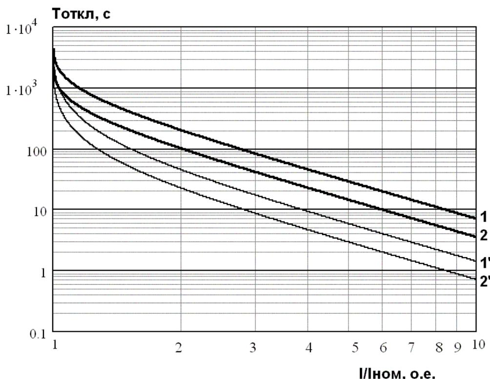
Рисунок 8 - Характеристики отключения тепловой модели двигателя
