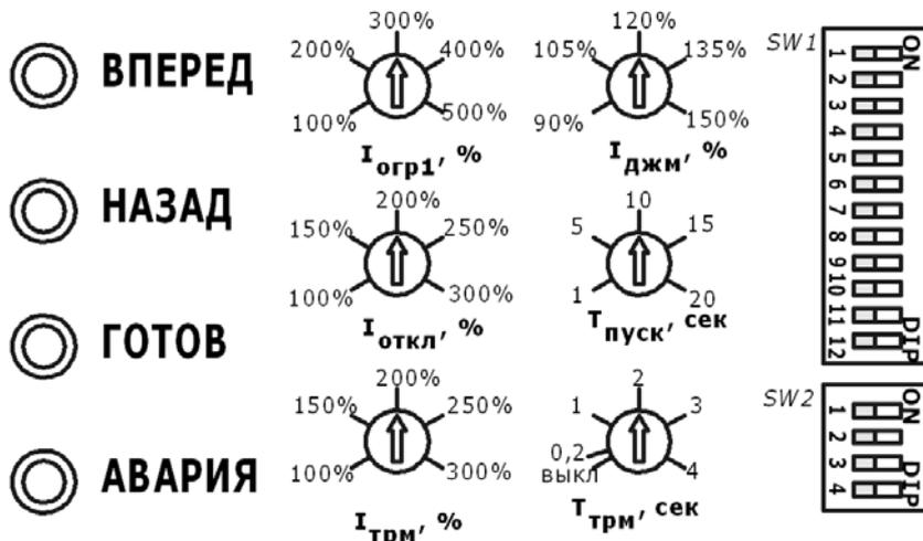
Рисунок 3 – Органы настройки пускателя
