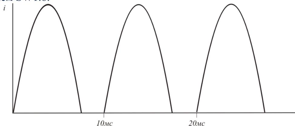
Рисунок 7 – Форма тока при динамическом торможении
