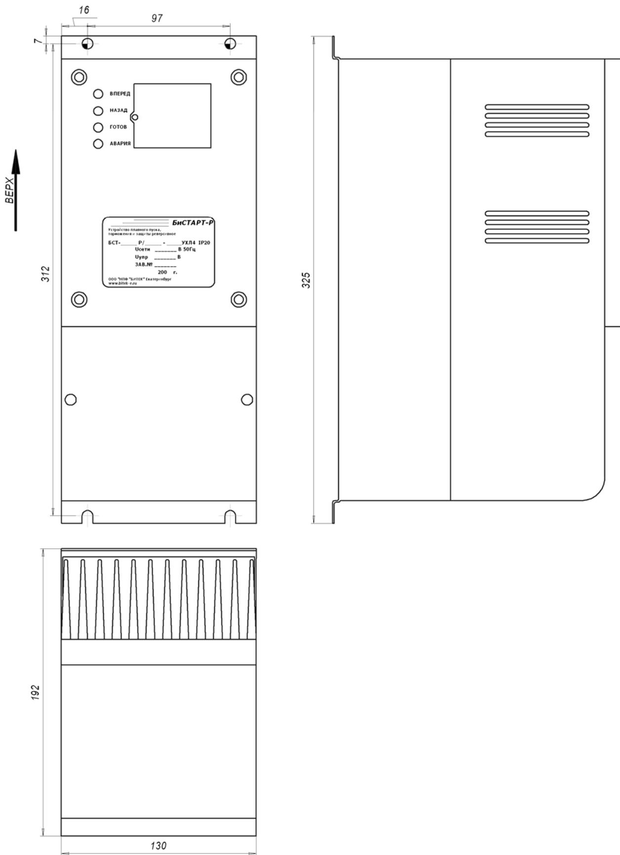
Рисунок 14 – Габаритные размеры
