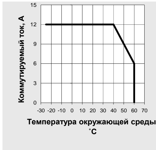
Рисунок 1 - Зависимость коммутлируемого тока от температуры окружающей среды.
